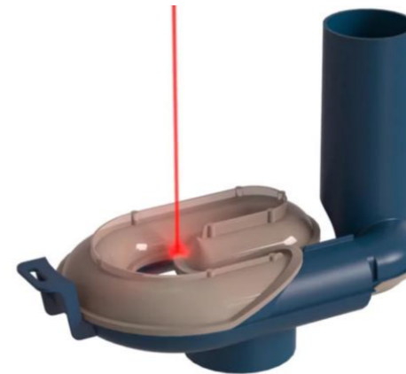
Die Absorption des Lasers im unteren Fügepartner erfolgt über ein Additiv im Ausgangsmaterial
